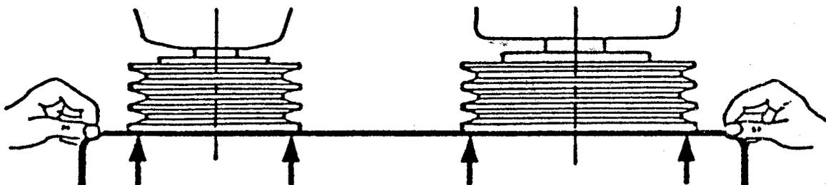
Vérifier et régler la tension des courroies. En appuyant sur chaque courroie avec un doigt, celle-ci doit pouvoir s'abaisser de 25 mm par rapport à sa position normale au repos.
