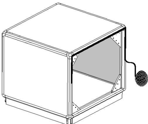
Placer le joint mousse fourni sur le profilé aluminium. Veiller à ne pas détériorer le joint lors des opérations de manutentions pour flasquer le caisson suivant.
