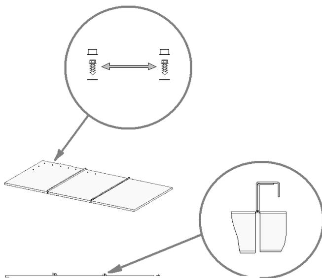
Les éléments de toiture doivent être emboîter l'un dans l'autre en partant d'une extrémité du Make-up.
